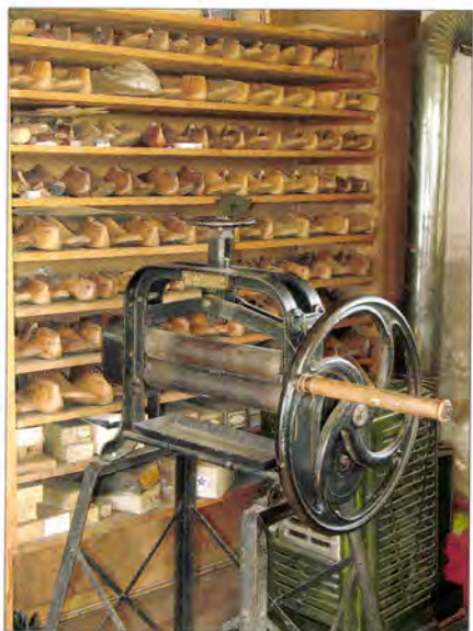
Schuhmacher-Werkstatt von Robert Gujer am Originalort. Im Vordergrund eine Lederwalze, die gebraucht wurde, um das Leder hart zu machen. Im Hintergrund das Gestell mit den Schuheleisten.
