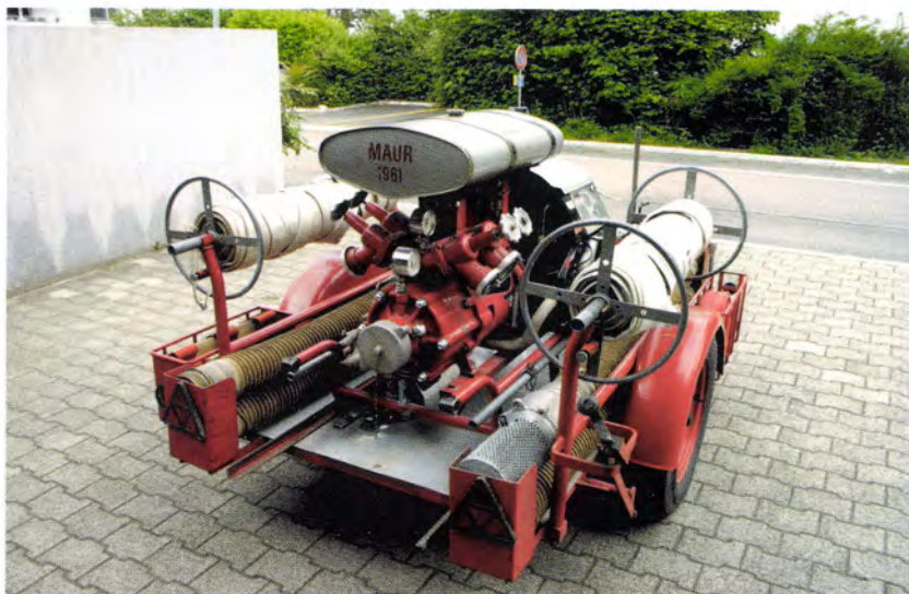
Motorspritze Vogt, Typ 2 – 1961, Motor: 4 Zylinder, 42 PS, Porsche Industrie. Leistung der Spritze: 1100 l/min.
