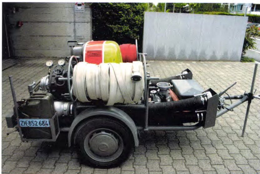
Motorspritze Vogt, Typ 2 – 1976, Motor: 4 Zylinder, 44 PS, VW Industrie. Leistung der Spritze: 1500 l/min.
