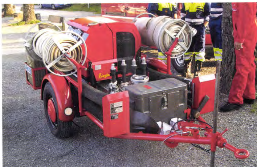
Motorspritze Vogt, Typ 2 – 2005, Motor: 4 Zylinder, 50 PS, VW Polo. Leistung der Spritze: 1800 l/min.
